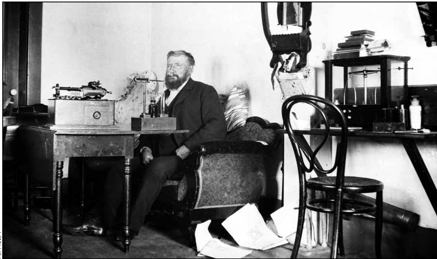
John C. Miller avec un des premiers émetteurs-récepteurs téléphoniques. Miller, qui fut le premier propriétaire d'un téléphone de la Miramichi, loua plus tard huit appareils téléphoniques dans le cadre d'une entente avec M. Robert R. Call. Ils firent aussi installer une ligne téléphonique privée sur une distance de sept milles entre Newcastle et Millerton, qui était reliée à leurs résidences, à leurs entreprises et à la gare de Newcastle.
